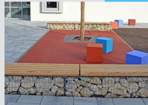
Die farbigen Betonwürfel lockern die Fläche auf, bieten Sitz- und Spielmöglichkeiten und bilden gleichzeitig die Absperzung der Fläche zur Feuerwehrrzufahrt.
